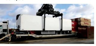
Transport combiné rail-route : système permettant de charger la semi-remorque complète sur un wagon poche
