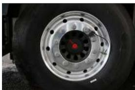
**TPMS = Système de surveillance de la pression des pneumatiques**
