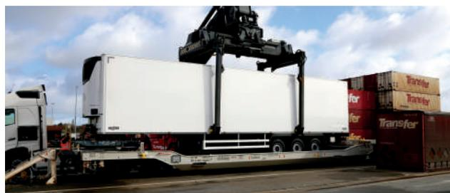
Transport combiné rail-route : système permettant de charger la semi-remorque complète sur un wagon poche
