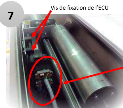
Fixation du module électronique et des connecteurs
