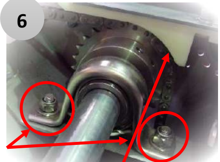
Fixation des pignons (2x) « chaîne » (2 vis radiales à 120°)
