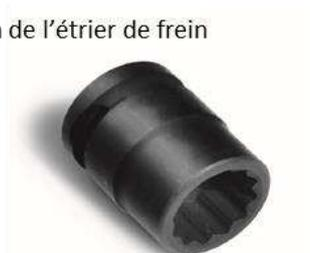
Clé polygonale / clef à fourche avec douilles, ouverture de clé 8 / 10 mm
