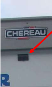
Barillet de désaccouplement moteur (7)
