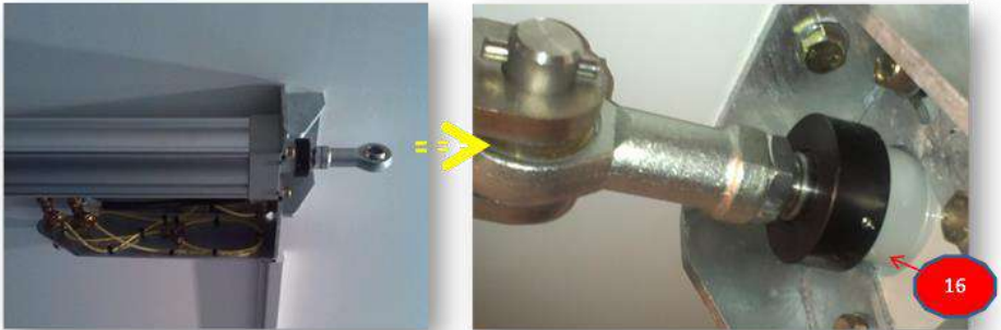
Figure 4 : Vérin pneumatique ; dans le cas d'une fuite, se référer à la page suivante et démonter le joint racleur
